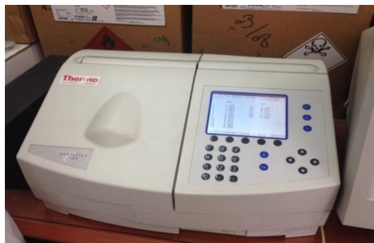
Figure 10 : Spectrophotomètre UV utilisé pour la lecture de l'absorbance
